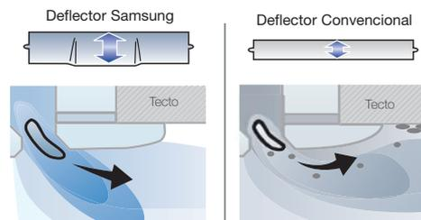
O fluxo de ar é direccionado para baixo, de forma a não entrar em contacto com o tecto.
